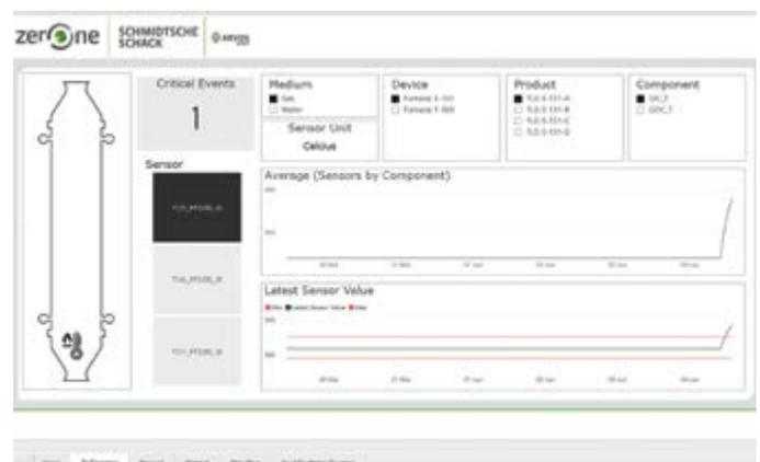
Zero.One® Dashboard zur Überwachung der Temperaturen
