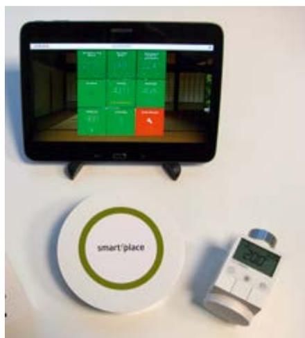
Abbildung 2: SmartrplaceBox mit steuerbarem Heizungsthermostat, das zugleich auch als Temperatursensor dient, und Tablet zur Bedienung einer Heizungssteuerung
