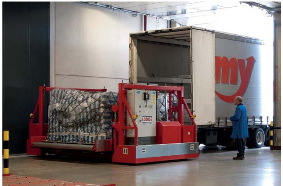
Lödige FlexLoader: Flexibles ferngesteuertes Transportsystem mit Akku-Antrieb für die Luftfrachtabwicklung
